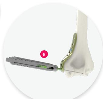
6. Mesurer la longueur de la vis directement sur la jauge guide (ANC1428) (c) ou avec la jauge de longueur (ANC102L) (e).
