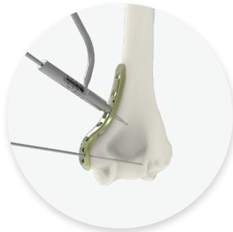
2. Dans un plot oblong, réaliser le perçage en utilisant la jauge guide non fileté coudée (ANC1030) et le foret Ø2.7mm (ANC1355).
