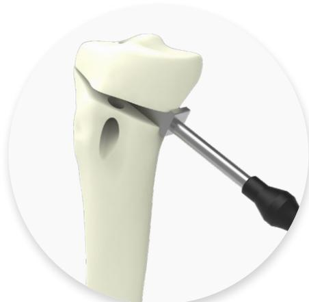
2. Réaliser le trait d'ostéotomie, en insérant des cales de taille progressives jusqu'à trouver la correction souhaitée (4-18 mm) tout en maintenant la surface latérale du tibia. Une fois introduite, la cale choisie maintient la correction angulaire pendant l'ostéosynthèse.
