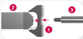
1. Insérer le guide de coupe NCT - élément 1 (ANC014-1) (1) dans le guide de coupe NCT - élément 2 (ANC014-2) (2), et visser la poignée sur l'ensemble (ANC024) (3).
