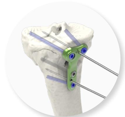
11. Répéter la même procédure que les étapes 6 et 7 pour insérer la vis verrouillée restante de Ø4,5 mm (ST4.5LxxDST) dans le trou situé sous la coupe d'ostéotomie. Les broches peuvent alors être retirées.
