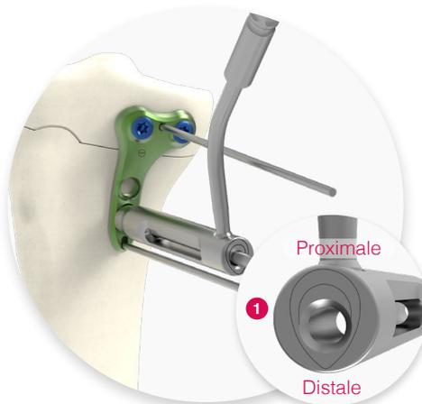
7. Forer dans la **partie distale du plot oblong à rampe** en utilisant la jauge guide (ANC1064) dédiée et le **foret Ø3.5 mm (ANC1075)**. L'orientation de la jauge guide doit être prise en compte pour réaliser la compression (1).
