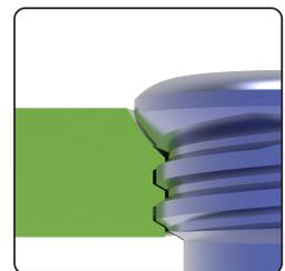
Le filetage sous tête de vis et le taraudage du plot de la plaque sont dotés des mêmes caractéristiques
