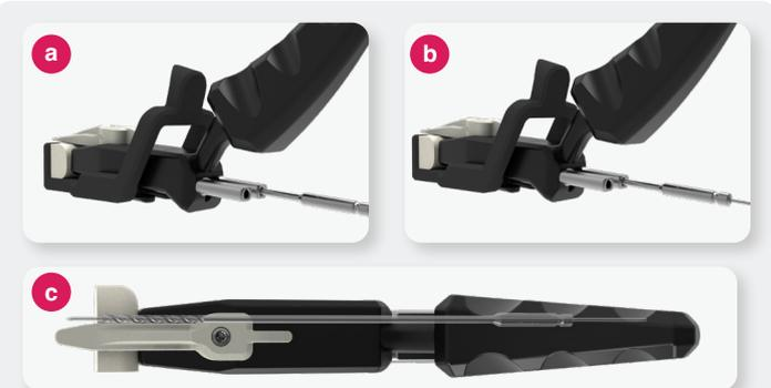
5. Glisser un foret (ANC918) dans un des instruments 2-en-1 (ANC915) (a) et insérer dans la butée une broche Ø1.2 mm (33.0212.200) (b) à travers sa canule.
