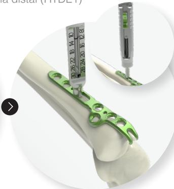
2. Dans le trou oblong, forer (ANC696) en utilisant la jauge guide fileté (ANC694) ou la jauge guide non fileté coudée (ANC695).
